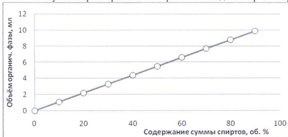
Рис. 1 - Залежність об'єму органічної фази (суміші спиртів) від вмісту суми спиртів при лужному розшаруванні водно-пропанол-ізопропанолової суміші ( V = 10,0 мл; t = 25 °С)
